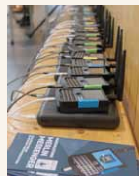
Durch Powerbanks und sparsame Komponenten halten auch die mobilen Geräte ohne Stromversorgung bis zu zwei Wochen durch.
